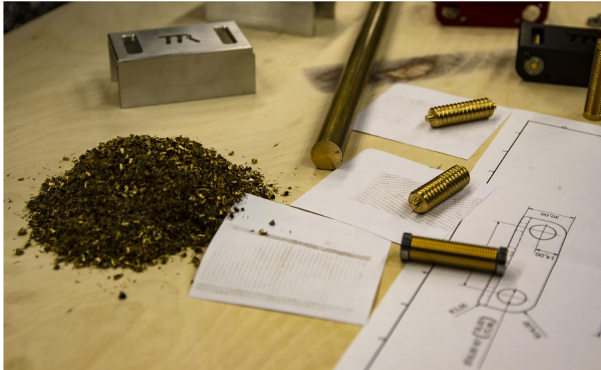
Olika rillar för olika väder och temperatur. På arbetsbordet ligger tre olika mönster. Mässingen gör att rillarna kan bli vassare än konkurrenternas.
