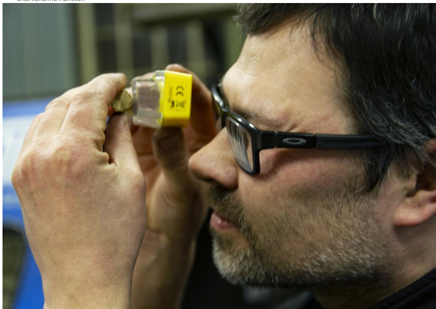
Under lupp. Mässing är ett känsligt material och varje rulle måste kontrolleras så att skidorna inte skadas. Bild: Johanna Hansson
