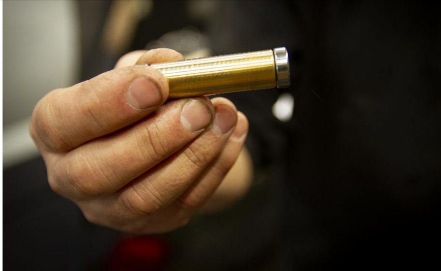
En mässingsrulle med rak struktur och 0,5 millimeters spår. Det näst minsta mönstret. Bild: Johanna Hansson
